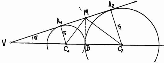
En la figura vemos que  $MC_1$  y  $MC_2$  son las bisectrices interior y exterior respectivamente correspondientes al vértice  $M$  del triángulo  $VMB$ . Por tanto: los centros  $C_1$  y  $C_2$  de dos esferas consecutivas son conjugados armónicos respecto del vértice  $V$  y del punto de contacto  $B$  de las esferas.
